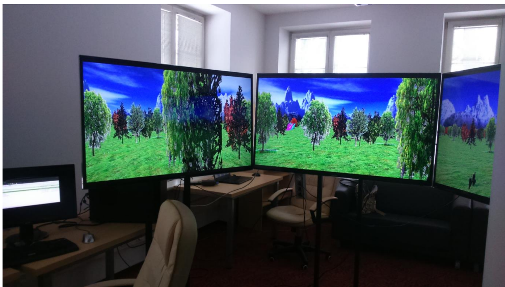
Rycina 39. System stymulacji wzrokowej (SSW) wyposażony w trzy monitory ekranowe do posturograficznego badania równowagi. Obraz prezentuje scenę wirtualnej rzeczywistości za pomocą trzech „kamer”. [Zdjęcie L. Czerwosz 2019].
